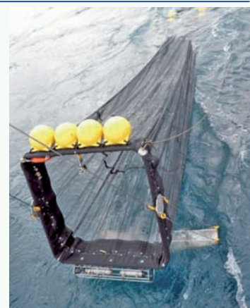
図1 コッドエンド開閉型層別採集ネット
