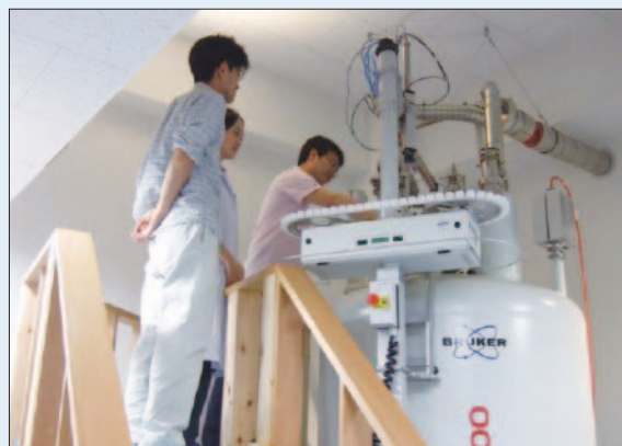
図2 NMR装置（800 MHz）
