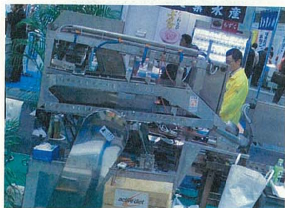
加工機械メーカーと共同開発したカタクチワシ頭揃え機（シーフードショー大阪2008. 1. 23-24）
