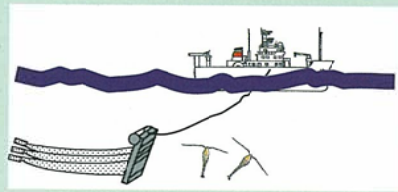
MOCNESSネットによる動物プランクトンの採集
